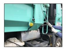
4 ロープを車両の前側へ移動させ、車両側面に括りつけて完了。
