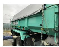
3 外したロープを車両の後ろまで 持っていき、ロープを引いて シートを巻き出す。
